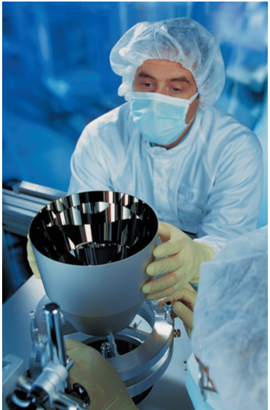
Optik der Zukunft: Spiegelsystem für das Muster eines EUV-Belichtungssystems (Extreme Ultra Violet) für kommende Chip-Generationen.
