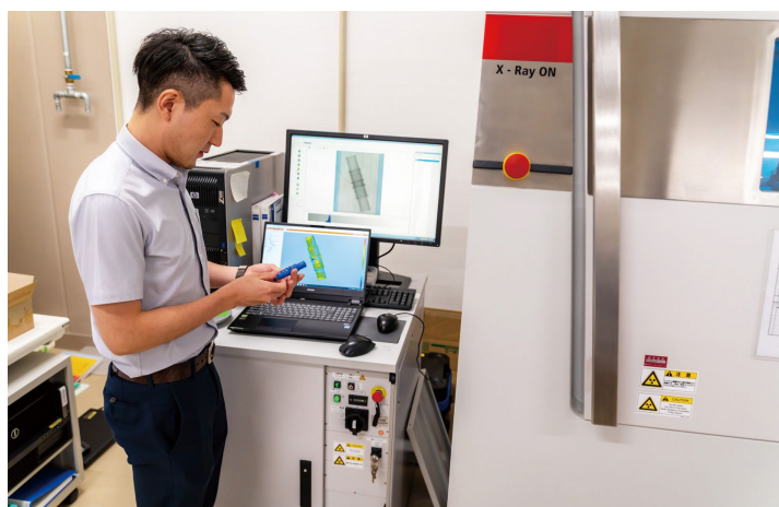
ZEISS METROTOM 800 130kVでスキャンを実行している様子
