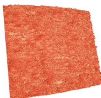
関心領域のスキャン 2 mm (ボクセル分解能：約 1.2 \mu\text{m} )
