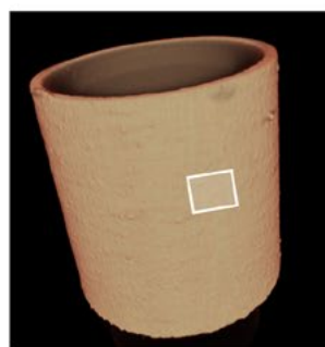
試料全体のスキャン 直径 10 mm (ボクセル分解能：約 11.5 \mu\text{m} )
