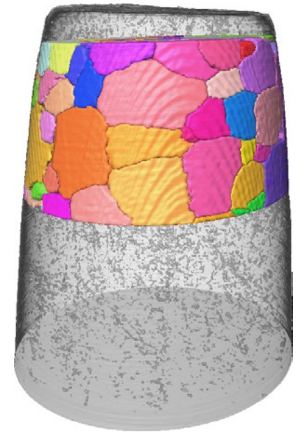
Al 2 Cu 合金の吸収および結晶粒情報。 ご提供：豊橋技術科学大学 小林正和教授
