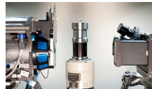
X 線源 (左)、引張/圧縮ステージの試料ステージ (中央)、検出器 (右)。X 線源から試料までの数センチメートルの距離に in situ 試料ホルダーを収容する場合でも、1 ミクロン未満のボクセルサイズを実現できます。
