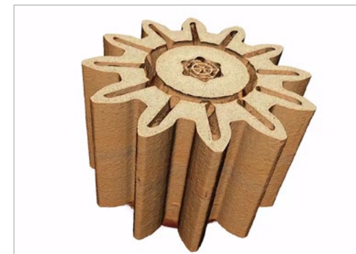
アディティブマニュファクチャリングで製造されたアルミニウム歯車の総合的な特性評価により、介在物や細孔、CAD モデルと相対的な寸法の偏差が明らかに。試料ご提供：Timo Bernthaler, University of Aalen
