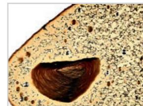
19 μm ボクセル分解能イメージングで、個々の特徴とポロジティを観察
