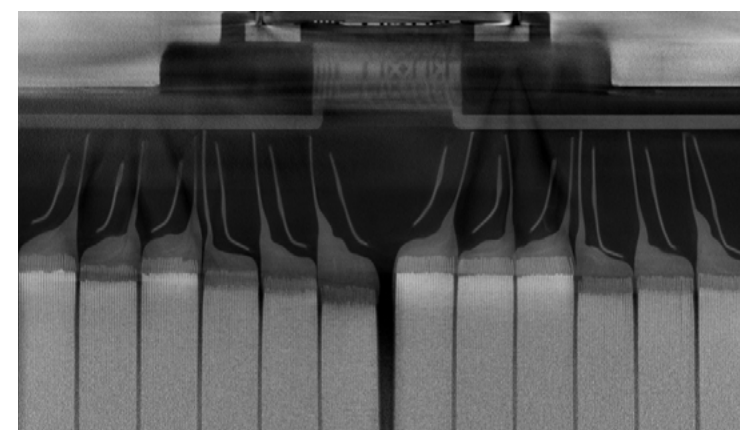
モジュールのオーバーハング検査
