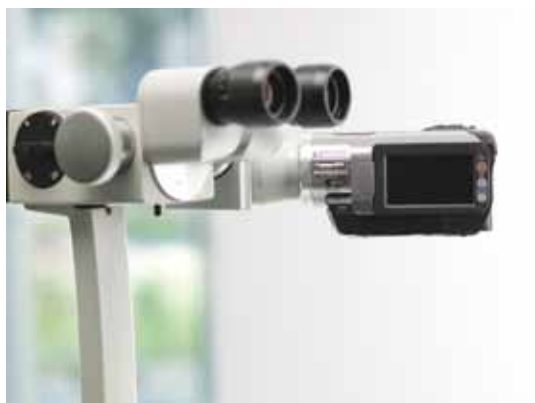
図 29 デジカムアダプター(写真のデジタルビデオカメラは別売り)
